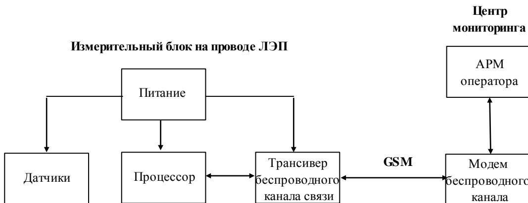
*Рис 2. Система мониторинга провода ЛЭП*
